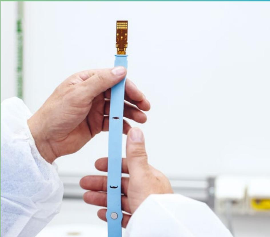
Intelligente Medizinprodukte – Kaiserslautern, Deutschland: Freudenberg entwickelt digitale Produkte für die Medizin der Zukunft. Der „Bambi Belt“ ersetzt bei Frühgeborenen die umständliche Überwachung mit Elektroden und Kabeln durch einen hautfreundlichen Silikongürtel.
